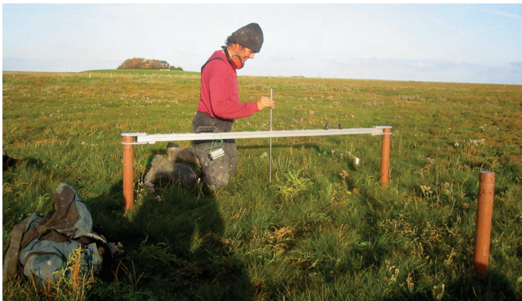
Abb. 27: Messung an einem SEB auf Langeness
